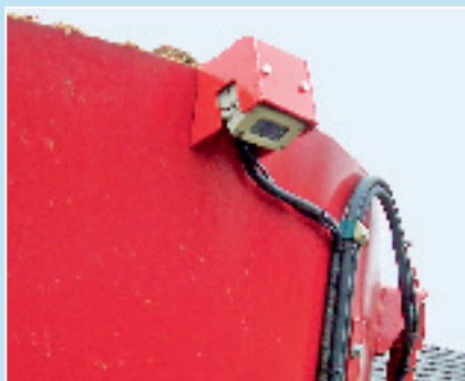
Landwirt Thomas Grünefeld hat zwei Kameras und einen Monitor im Einsatz: eine teurere Kamera am Futtermischwagen und eine kostengünstige am Ladewagen.
